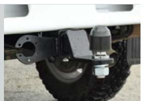
Тип соединения: шаровый; Диаметр сцепного шара: 50 мм.; Масса комплекта ТСУ GAZ991101: 18,1 кг.
