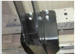
**ШАГ 3.** Закрепите кронштейн сварной на круглой балке с помощью кронштейна гнутого, соединив обе детали с помощью двух болтов M10x40x1,25 через шайбы на 10 и гроверы на 10, гайками M10x1,25, и болтов M12x45x1,25 через шайбы на 12 и гроверы на 12, гайками M12x1,25 снизу, как показано на схеме.
