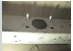
**ШАГ 2.** Установите кронштейн сварной и закрепите его болтами M10x40x1,25 с помощью гаек M10x1,25 через шайбы и гроверы на 10, как показано на схеме.
