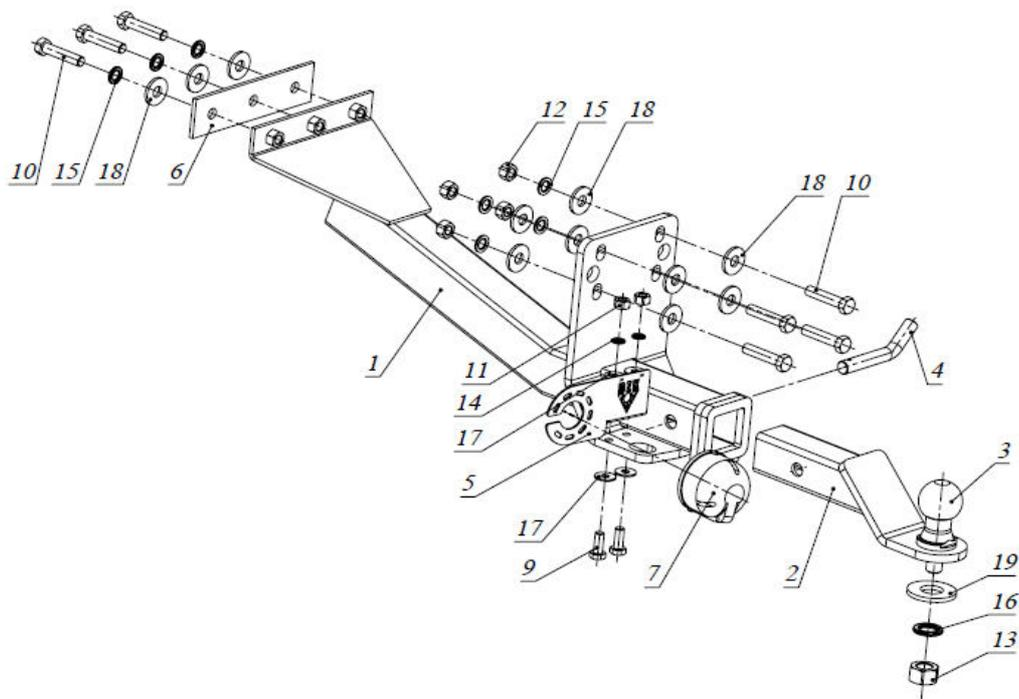
1. Установить раму 1, закрепив ее болтами М12х40 к поперечной балке (рис.1).
