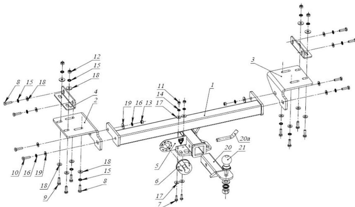
1. Прикрутить кронштейны 4 болтами М10х1,25х25 к штатным резьбовым отверстиям в лонжеронах а/м с внешней стороны.
