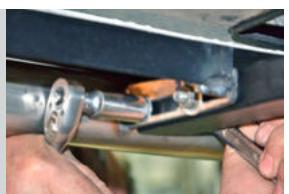
Затяните крепления кронштейнов и силового элемента.
