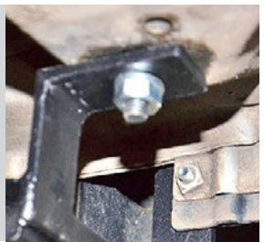
Совместите задний кронштейн крепления с технологическим отверстием в ребре усилителя порога и соедините их с помощью болта M8, входящего в комплект поставки, шайбы M8 и гроверной шайбы M8.
