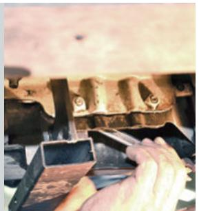
Установите передний кронштейн крепления через закладную шпильку M10, соединив гайкой M10, шайбой и гроверной шайбой M10. Совместите передний кронштейн крепления с технологическим отверстием в ребре порога и соедините их с помощью болта M8, входящего в комплект поставки, шайбы M8 и гроверной шайбы M8.
